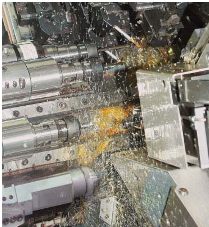
Huit sur le coup: sur la MultiDECO 20/8d, 8 broches avec vitesses de rotation indépendantes sont mises en oeuvre simultanément. La productivité pour les pièces complexes est augmentée d'une puissance deux! Selon la structure de la commande, une évaluation de l'achat d'un tour automatique multibroche vaut le détour.
