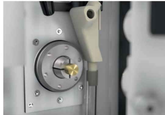
La pince pour diviseur F22, permet de serrer des barres jusqu'à 16 mm de diamètre. En option et après analyse du serrage il est possible de monter une pince F35.
