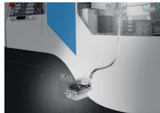
effiziente Werkstückübernahme. Die Steuerung des Vakuumsystems erfolgt bequem über eine M-Funktion der CNC. Das System verfügt über zwei Schalen für die Werkstückübernahme. Die Schalen sind aus Kunststoff und entsprechend konzipiert, um permanent ein Ölniveau aufrechtzuerhalten, das die Ankunft des Werkstücks in der Schale dämpft. Darüber hinaus können die Schalen auch zum Auffangen von Teilen mit einem Sieb mit zwei verschiedenen Filtergrößen – 60 und 250 Mikrometer – verwendet werden.
