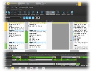
2) Un'interfaccia di manipolazione macchina, che sostituisce le pagine FANUC, denominata «TISIS Pilot ».
