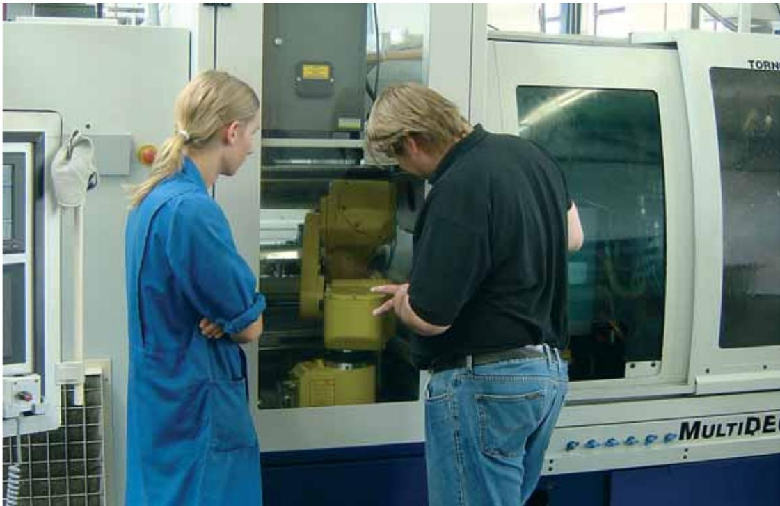
Tornos CNC-Mehrspindel-Drehautomat mit integrierter Roboterzelle der Firma Handling Tech.
