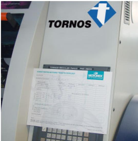
Las hojas de control de parámetros de corte de MOTOREX permiten representar todos los parámetros relevantes de forma clara y comparativa. La hoja puede colgarse sencillamente en la máquina mediante imanes y archivarse a continuación con la pieza de muestra.
