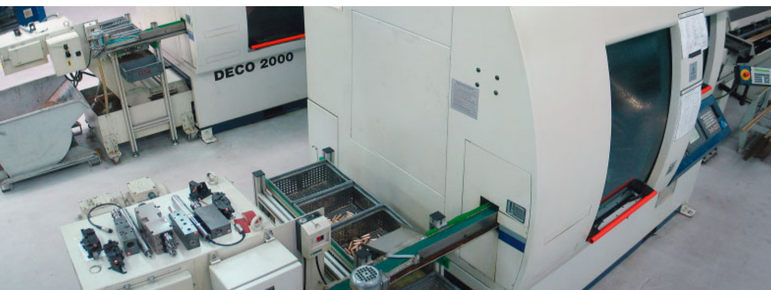
Cellule de production DECO. On peut voir au premier plan les appareils et outils prêts à être montés pour l'usinage de la série suivante.
