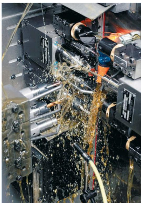
“Sui nostri torni CNC, alcuni particolari torniti richiedevano due operazioni iniziali e una o due operazioni supplementari per completare i cicli di foratura e di maschiatura”, dichiara il Signor John Kent, direttore della Paragon. Adesso con la DECO 20a, possiamo realizzare dei particolari torniti ad ogni estremità (con una lavorazione altamente prismatica) in un solo passaggio. Secondo le mie valutazioni, abbiamo ridotto i tempi del ciclo, in media, del 40%.”
