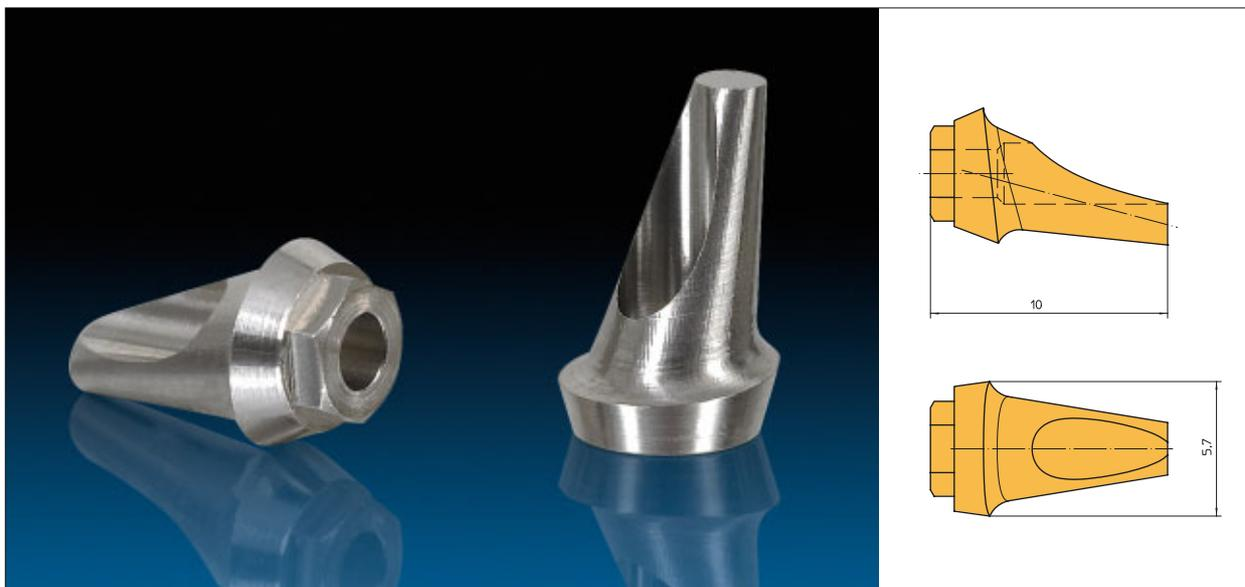
Il genere di sfida che i Techno Hubs sono pronti a fronteggiare. Una intelligente combinazione di cinematica della macchina con la potenza dell'informatica hanno permesso la realizzazione di questi impianti in un solo serraggio: guadagni di tempo impressionanti per il cliente.
