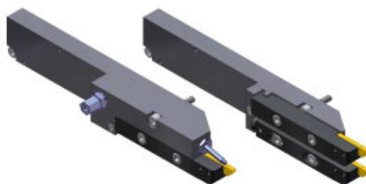
Il cambio degli utensili su Sigma 20 risulta essere molto più agevole. In effetti con il sistema MODU-LINE si smontano solo i porta-plachette. I porta-utensili, la cui massa è a volte piuttosto rilevante, rimangono fissati alla macchina.
