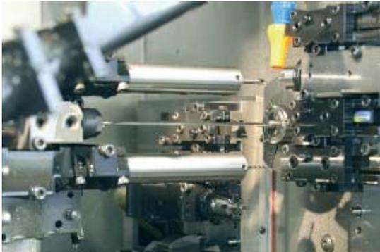
Damit auf einem Bearbeitungszentrum wie z.B. einer TORNOS DECO 20a tiefgebohrt werden kann, sind eine Tiefbohrvorrichtung und eine leistungsfähige Hochdruck-Kühlvorrichtung notwendig. Beim Tiefbohren von hoch legierten und nichtrostenden Stählen, wie sie in der Medizintechnik verwendet werden, spült das Bearbeitungsfluid unter sehr hohem Druck die Späne laufend aus der Bohrung.
