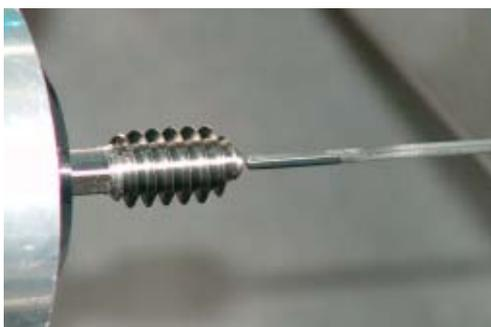
120-bar-Hochdruckbohren, an Führungsbuchse und in
