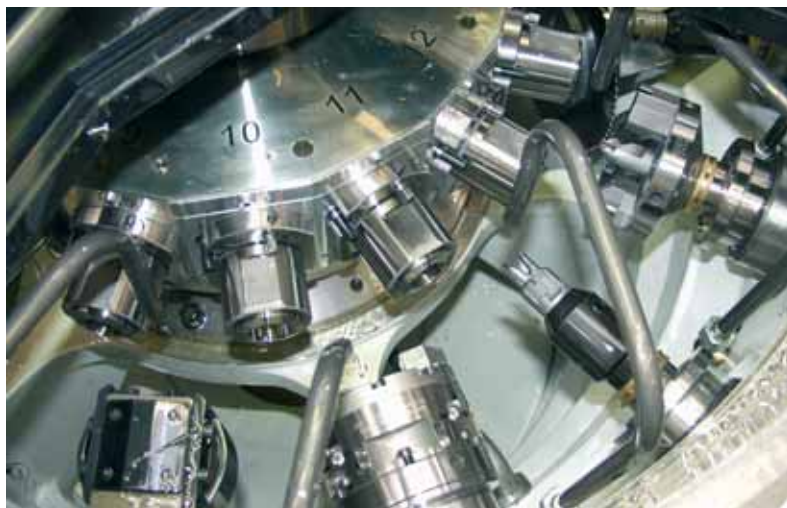
Gut zu sehen: Auf der Innenseite die Werkstückhalter der Stationen 10 bis 13 und auf der gegenüberliegenden Seite die unterschiedlichen Werkzeuge, die während der Bearbeitung rotieren und sich sowohl auf der Längs- als auch auf der Querachse bewegen.
