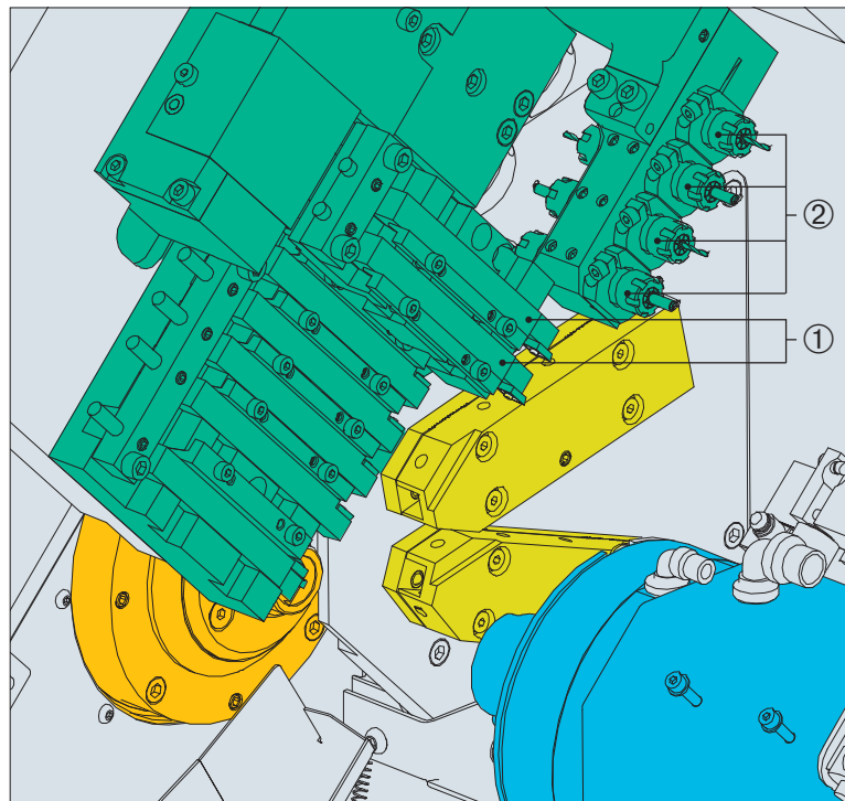
Die Werkzeugaufnahme für die Gegenbearbeitungs-Werkzeuge dient ebenfalls zur Aufnahme einer Transversal-Bohrereinrichtung. Pos. ① Die Zylinder mit den Werkzeugaufnahmen von Applitec sind in die Gehäuse der Gegenbearbeitungs-Bohrwerkzeuge eingefügt. Pos. ②
