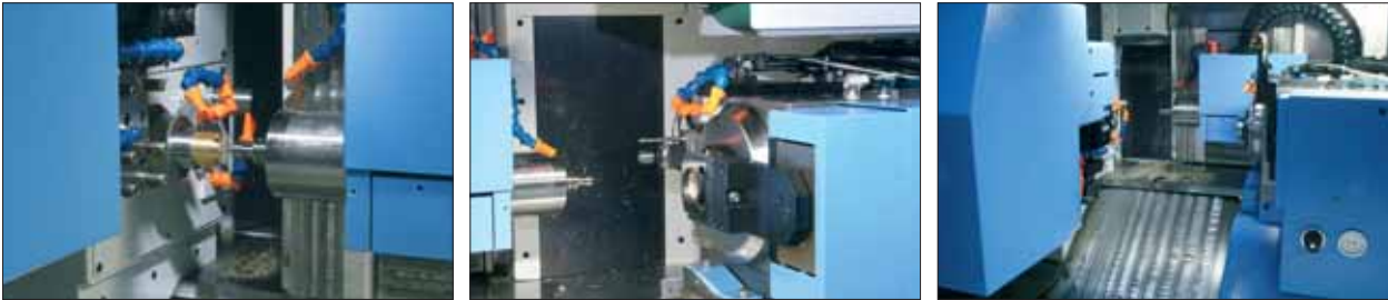
Blick auf die Hauptspindel: Das Bearbeitungszentrum ist bereit zur Bearbeitung der ersten Seite einer neuen Platine direkt auf der Stange. Die Gegenspindel wartet auf die Platine, um deren zweite Seite zu bearbeiten... ...und holt sie direkt bei der Hauptspindel ab.
