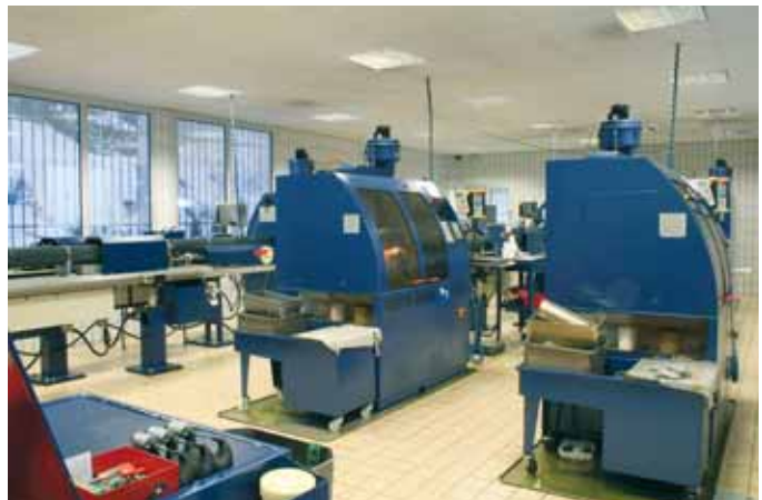
Einer der Produktionsräume, ausschliesslich mit Drehautomaten DECO 2000 eingerichtet. Auch hier herrscht eine absolut saubere Umgebung.
