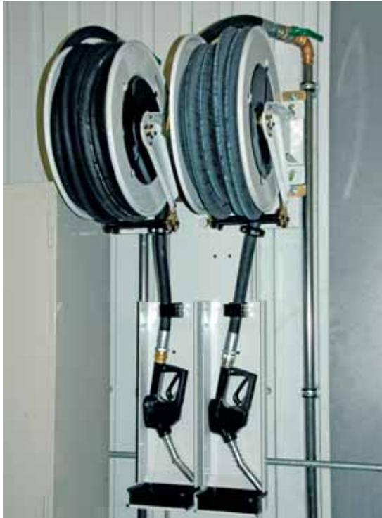
Mit den wandmontierten Schlauchrollen lassen sich die Versorgungscontainer zentral und in der Nähe der Maschinen befüllen. Eine Füllstandsanzeige am Container und eine Abstellautomatik schützen dabei vor dem Überfüllen.
