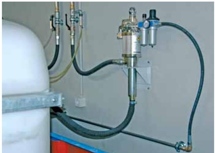
Leistungsstarke pneumatische Pumpen versorgen die Fluid-Versorgungs-Säule an der zentralen Ausgabestation in der Maschinenhalle. Dank dem universell einsetzbaren Schneidoel MOTOREX ORTHO NF-X konnte das Fluid-Handling extrem vereinfacht werden.
