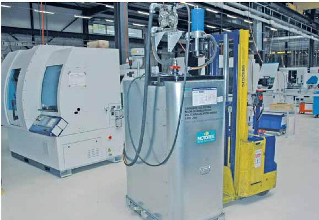
Für die Befüllung und Entleerung der Maschinen stehen mehrere dieser doppelwandigen Container zur Verfügung. Sie sind wie Paletten transportierbar und jeweils mit einer Pumpe und einer Filter-Einheit ausgerüstet.
