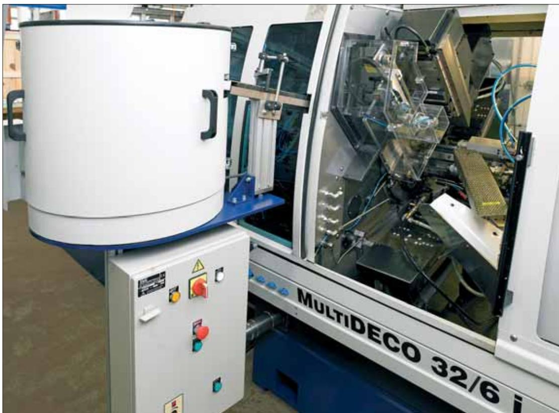
Zuführsystem über „Rutsche“ in Verbindung mit einem Vibrationsförderer.
