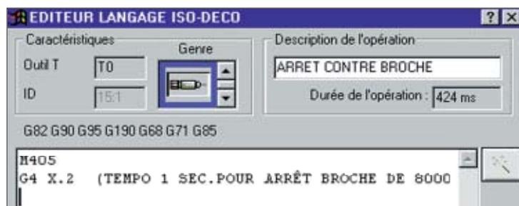
3. Abänderung in der Bearbeitung 15:2 des Tempos G4 X1 durch G4 X.75, was der Gegenspindel eine Gesamtstillstandszeit von 976 ms bis zur Wiederaufnahme der Rotation gibt. In diesem Fall kann man das auf jedes Werkstück anpassen, denn es handelt sich um eine grösstenteils in Hauptparallelzeit liegende Zeit.
