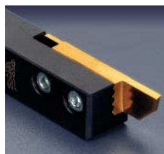
APPLITEC schlägt bei den meisten ihrer Werkzeuge des Typs 700 die Einspannmöglichkeit auf dem selben Werkzeugträger vor (von der, der Schneidplatte gegenüberliegenden Seite). Zwei kleine gewindegeschnittene Einfügungen werden dann in den Schneidplatten hinzugefügt. (Einspannung Typ B).
