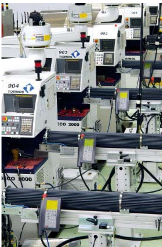
Das Unternehmen besitzt acht Tornos DECO 10 mm- 9-Achsen-Maschinen zur Ausführung von zahlreichen komplizierten Bearbeitungsvorgängen in einem einzigen Durchgang. Eine seiner Stärken liegt in der erfolgreichen Durchführung von Polygonfräsoperationen auf den Maschinen.
