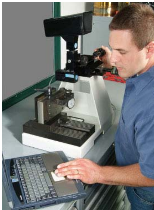
Tornos bietet für seine DECOs ein Werkzeugvoreinstellgerät, mit dessen Hilfe die Werkzeuge für die nächste Serie bei fortgesetzter Produktion der Maschinen einstellbar sind.
