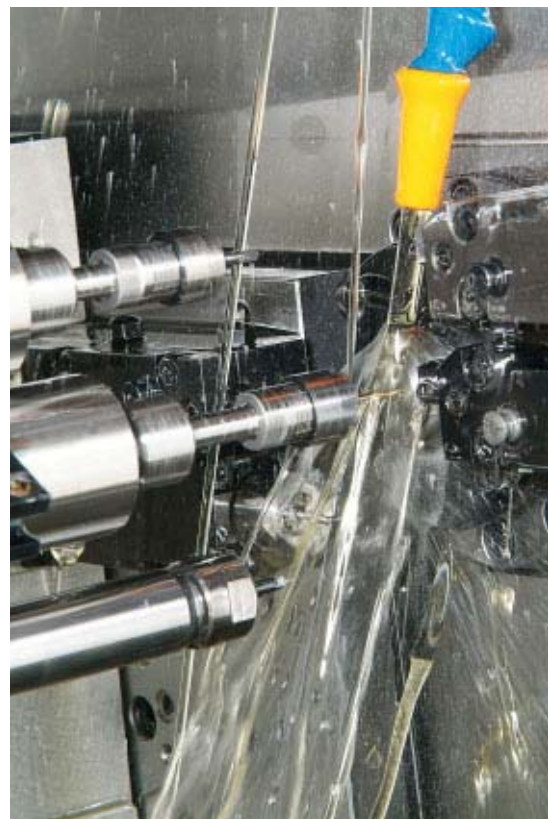
Innenansicht einer der DECO-Maschinen – oben der nützliche Polygonfräsapparat.
