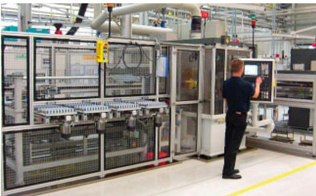
Schleifbearbeitung in höchster Genauigkeit vollautomatisiert.
