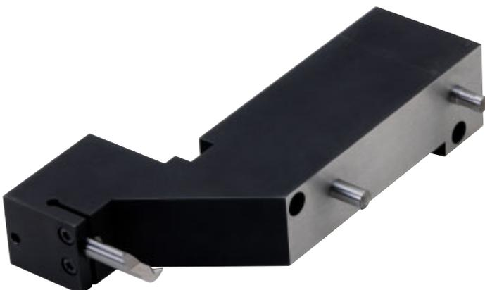
Abbildung 6: Monoblock-Werkzeughalter für DECO-Maschinen
