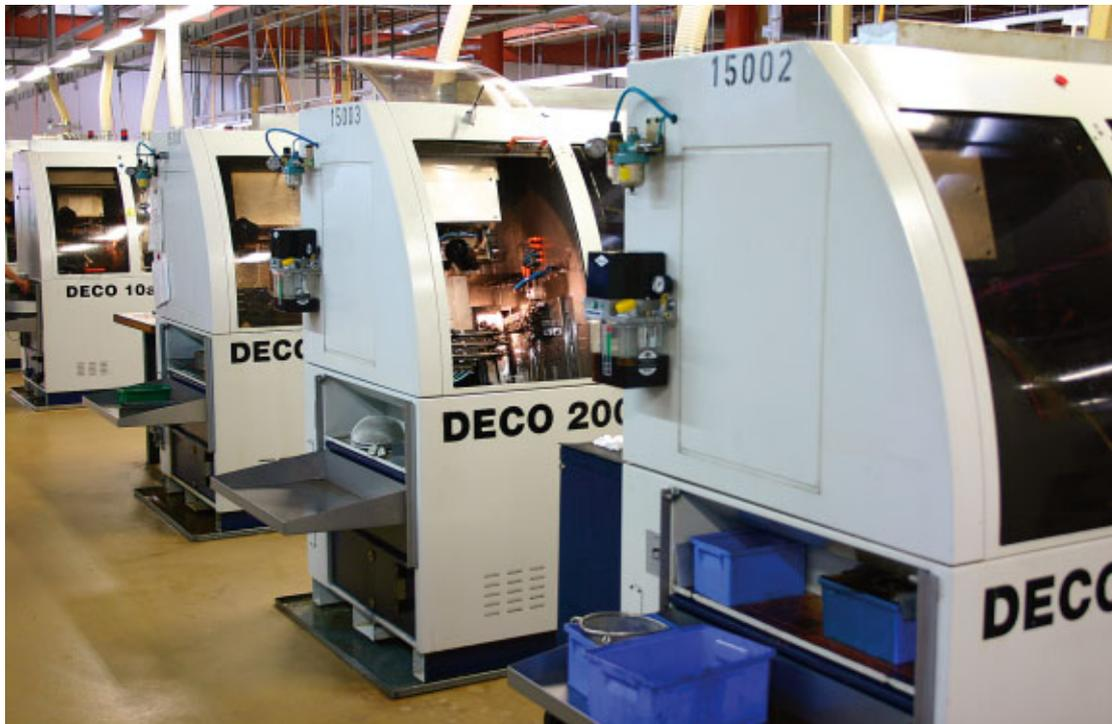
Ein Drittel des Maschinenparks besteht aus CNC-Drehautomaten von Tornos.
