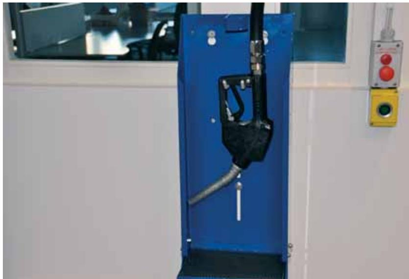
Natürlich werden bei Stryker Spine die Bearbeitungsfluids zentral gelagert und über Zapfpistolen in unmittelbarer Nähe zum Bearbeitungscenter ausgegeben. Bei jeder Maschine wird der Zustand des Schneidools regelmässig überwacht.
