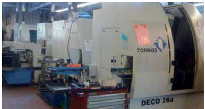
Einblick in die DECO-Werkstatt bei Decovi. Alle Maschinen sind an der zentralisierten Öldampf-Abzugsvorrichtung angeschlossen.
