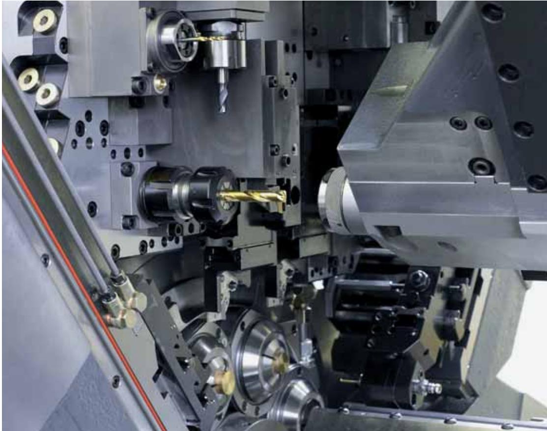
Durch die beiden Gegenspindeln, welche je auf einer Achse montiert sind, können die Teile nach dem Abstechen abgegriffen und auf der Teilerückseite bearbeitet (Drehen, Bohren, Fräsen, usw) werden.
