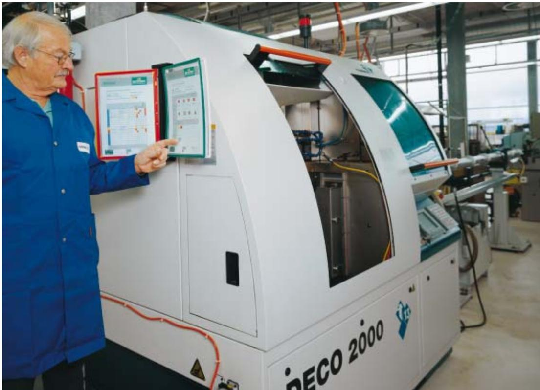
Jede Maschine wird erfasst und mit den PFM-Farb- und Barcodesystem leicht verständlich beschriftet.
