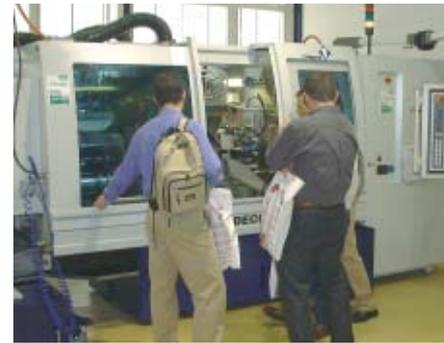
Mit der neuen MULTIDECO bietet TORNOS heute eine umfassende Palette an Mehrspindelmaschinen (6 und 8 Spindeln) für Bearbeitungsdurchmesser von bis zu 20 mm an. Diese Kombination aus Leistung und überragender Technologie ist bisher einzigartig.
