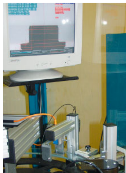
Automatisches, hochgenaues Messen von Décolletageteilen basiert auf einem vorgegebenen CpK-Wert. Die Teile werden stichprobenweise gemessen und mit einer Sollmasszeichnung verglichen.
