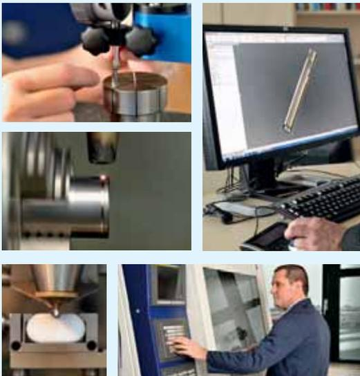
Das Bearbeitungszentrum CU1007 ist in vier Grundausführungen erhältlich: mit 3 Achsen, 4 ½ Achsen, 5 Achsen (4 Simultanachsen) und 5 Simultanachsen. So kann diejenige Konfiguration gewählt werden, die dem zu fertigenden Teiletyp am besten entspricht. Die Maschine kann zudem mit einem System für die Werkstückbeschickung und -entladung in Form eines Roboters mit 6 Achsen ergänzt werden.
