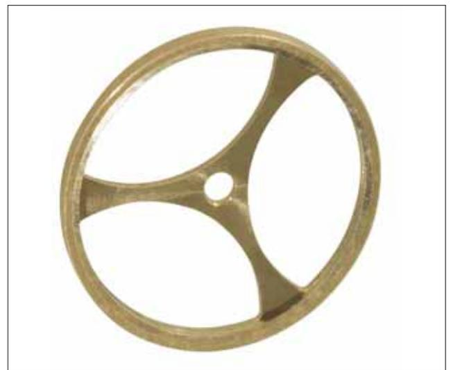
Es ist nun möglich, diese Art von Teilen auf einem mit Hochfrequenzspindeln ausgerüsteten Drehautomat auszuführen. Die Tatsache, dass das Werkzeug nicht mehr auf einem anderen Produktionsmittel bearbeitet werden muss, bedeutet, dass die Ausschussrate erheblich reduziert wird.
