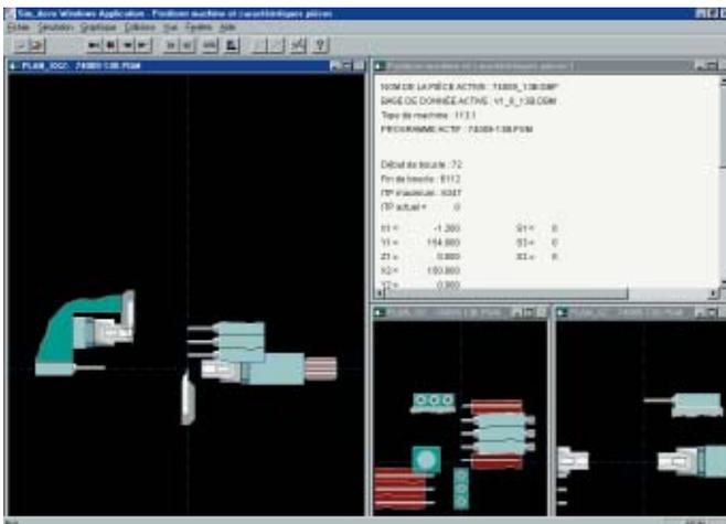
Um die Drehautomaten-Kinematik voll auszunutzen, muss eine gewisse Hauptparallelzeit-Arbeitsmethode angewandt werden (Gegen-Bearbeitungen, Werkzeugsvorbereitung, usw...). In der TB-DECO Software haben wir ein Programm-Modell als Empfehlung der Bearbeitungsfolgen erstellt. Dieses Modell gestattet somit dem Operator, aus den zwei Werkzeugsystemen Nutzen ziehen zu können (gegenüber vier auf DECO
