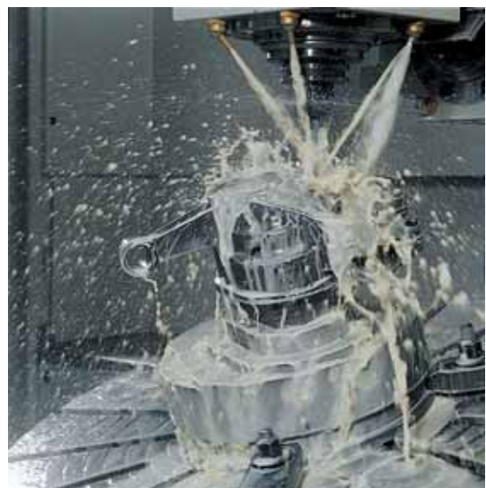
Schneidemulsionen schmieren, kühlen und spülen die Späne weg – eine anspruchsvolle Aufgabe. (Foto: Blaser)
