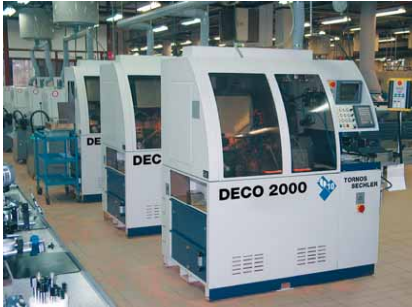
DECO-Werkstatt. Wie bei den Mehrspindeldrehmaschinen ist auch hier jede Maschine am zentralen Luftreinigungssystem angeschlossen.
