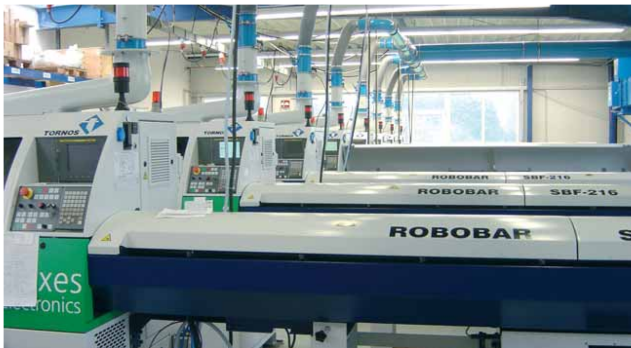
Ordentlich in Reih und Glied stehen die acht Tornos CNC-Einspindeldrehautomaten in der modernen Fertigungshalle von Conec.
