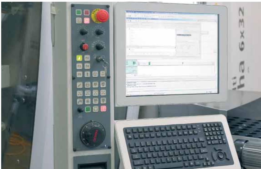
Mit der verstellbaren Tastatur mit integrierter Maus erleichtert die neue Tornos-Steuerung die Programmierung und macht sie sogar auf der Maschine möglich.
