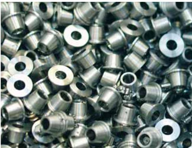
Über 15'000 dieser nur ca. 4 mm hohen Teile werden täglich hergestellt. Die Prüfung geschieht vier Mal täglich mit immer sechs Teilen (1 Drehteil pro Spindel). Die Ergebnisse werden exakt in das Messprotokoll eingetragen.
