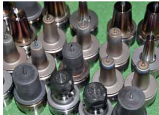
In modernen Bearbeitungszentren werden für jede einzelne Operation die unterschiedlichsten Werkzeuge eingesetzt. Der Wechsel findet vollautomatisch statt.
