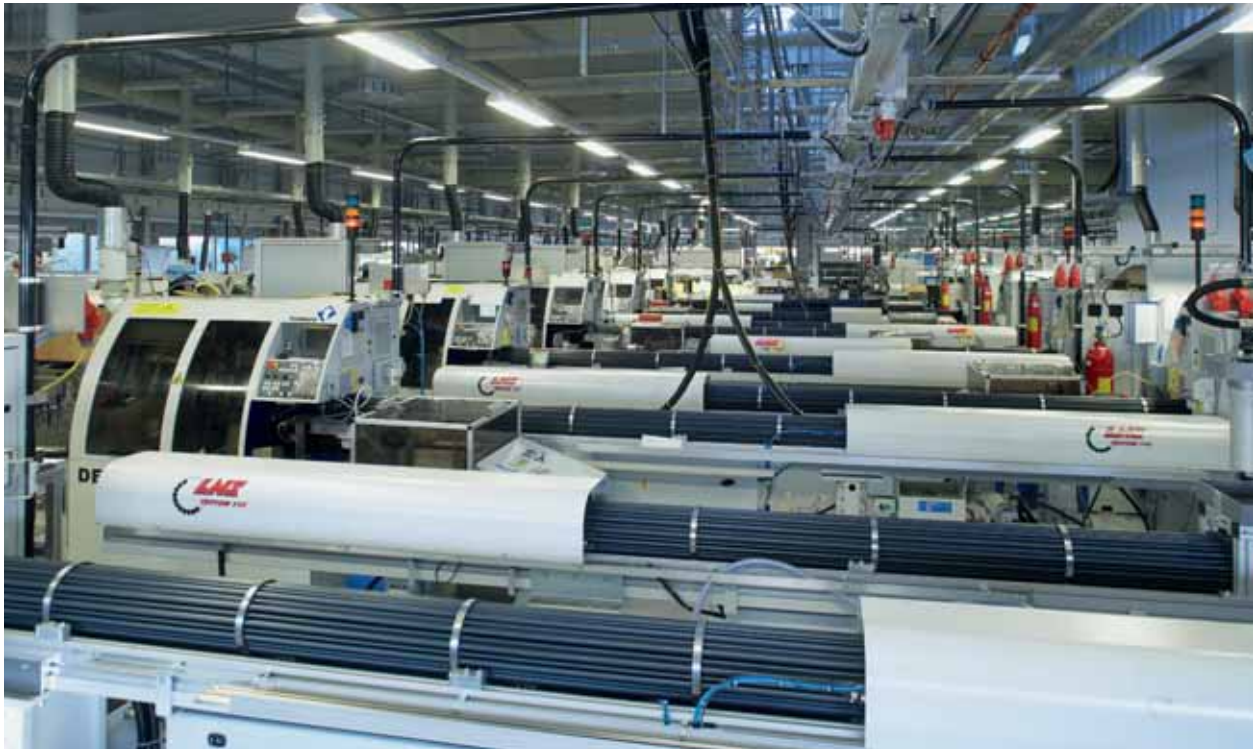
Im hochmodernen Maschinenpark von Prefag dominieren beim Drehen eindeutig die CNC Einspindeldrehautomaten von Tornos.
