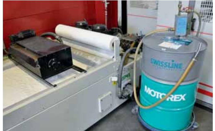
Mit dem Bandskimmer wird das Leckoel „abgeschöpft“ und über den Bandfilter feinste Späne oder Metallpartikel ausgefiltert. Gut sichtbar auch das kompakte und immer benötigte KSS-Mischgerät auf dem mobilen Motorex-Fass.
