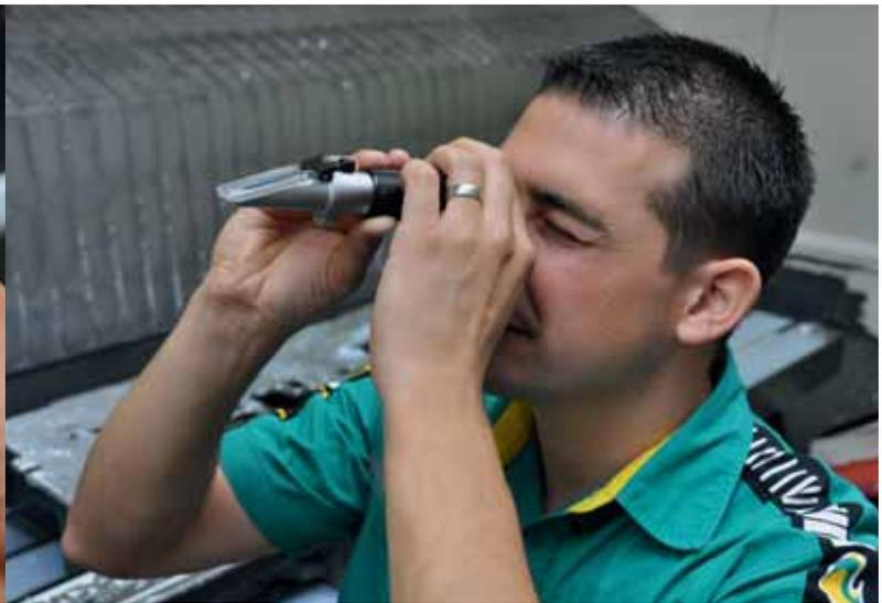
Das Ermitteln der Konzentration (Anteil KSS-Konzentrat in % und Wasser) kann mit einem optischen Refraktometer oder einem elektronischen Messgerät einfach und präzise ermittelt und in das Maschinenlogbuch eingetragen werden.
