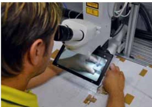
Die Maulteile der Fasszange sind über Gelenke mit einem Zugansatz verbunden. Hier wird dieser mit einer Saite unter einer optischen Vergrößerung mit Laser verschweisst.
