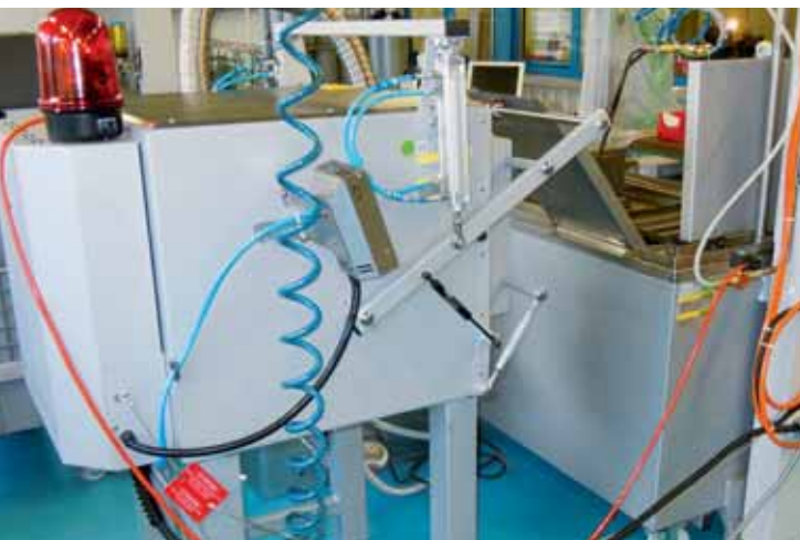
Härteanlage für die rentable Fertigung von Spannzangen in Kleinserien.
