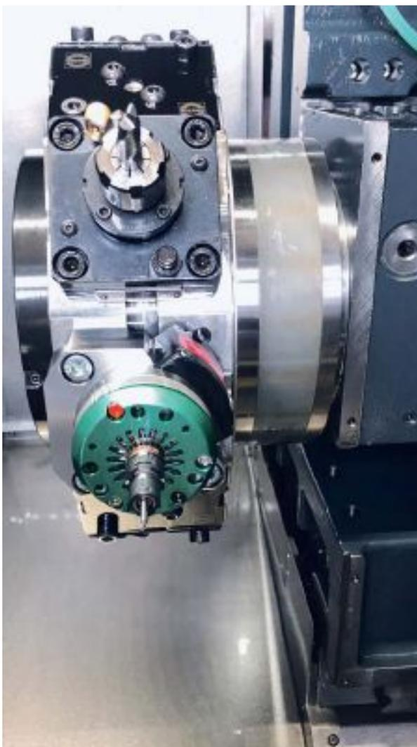
nell'intervallo di velocità più elevato, l'azionamento degli utensili della macchina CNC non è necessario, con conseguente funzionamento ottimale. Ne risultano un'usura minore e quindi una durata maggiore del mandrino della macchina. Un altro aspetto importante è la riduzione del rilascio di calore nell'azionamento utensili a velocità elevate.
