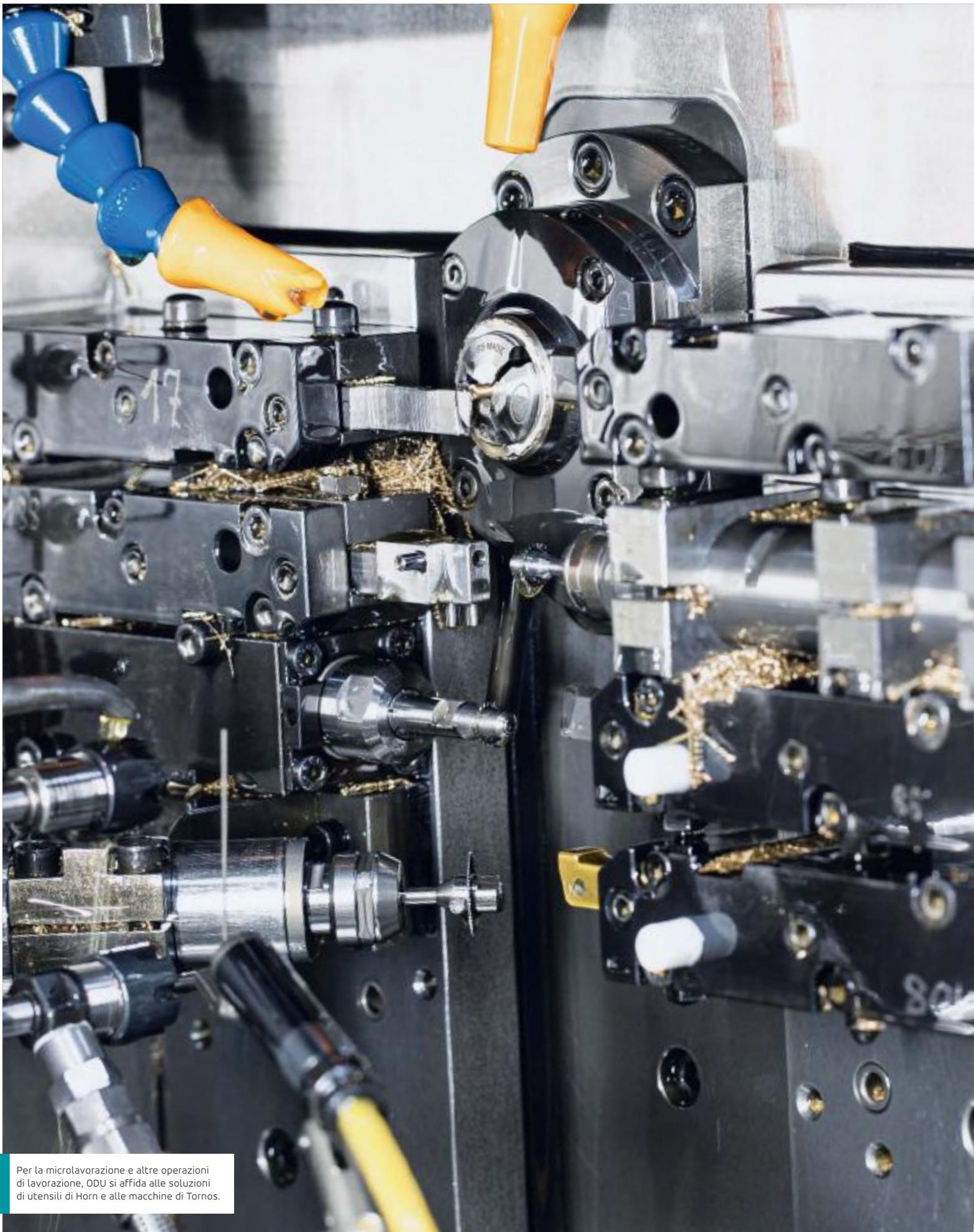
Per la microlavorazione e altre operazioni di lavorazione, ODU si affida alle soluzioni di utensili di Horn e alle macchine di Tornos.
