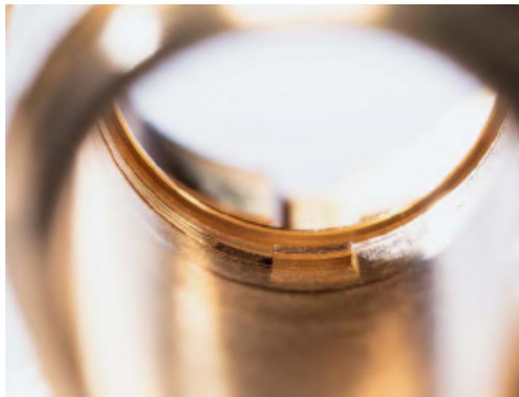
La timbratura del tallone di posizionamento ha rappresentato una sfida nella progettazione dello strumento.
