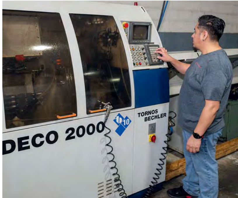
Premier Swiss 的机床操作员 Paul Ramos 正在操作 Tornos DECO 10。该公司目前拥有七台 DECO 10、六台 DECO 20、两台 DECO 26、一台 DECO 13 和一台 Swiss GT 26。
