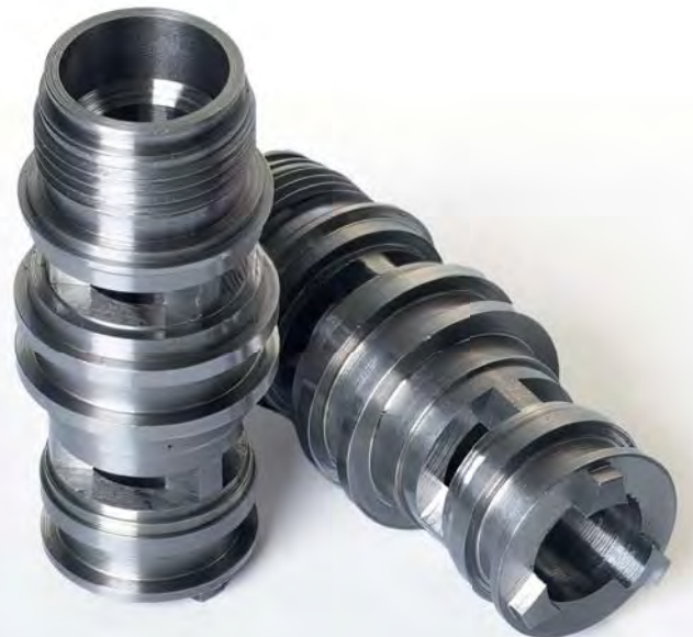
在 Tornos DECO 20 上加工的 AISI 1215 碳钢工业液压元件
