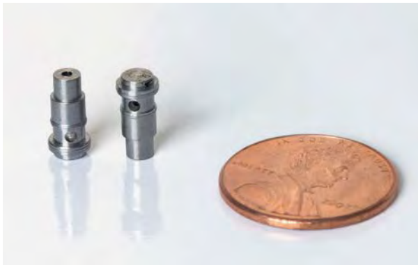
在 Tornos DECO 10 上加工: 420 不锈钢医疗器械部件
