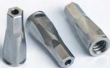
Componentes de titanio para instrumental médico, mecanizados por expertos en la Tornos DECO 20.
