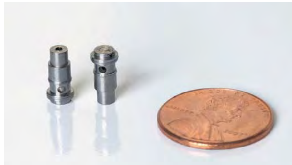
Mecanizados en la DECO 10 de Tornos: componentes de acero inoxidable 420 para instrumentos médicos
