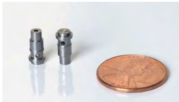
Usiné sur la Tornos DECO 10: acier inoxydable 420 composants d'instruments médicaux
