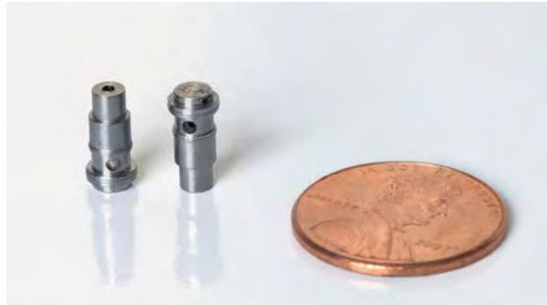
Lavorati su Tornos DECO 10: componenti di strumenti medici in acciaio inox 420.
