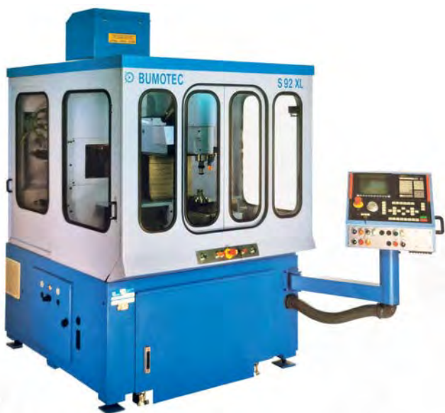
Bumotec S-92XL, 3- do 5-osiowe maszyny CNC w konfiguracji jednowrzecionowej lub wielowrzecionowej, produkowane na początku lat 90-tych.
