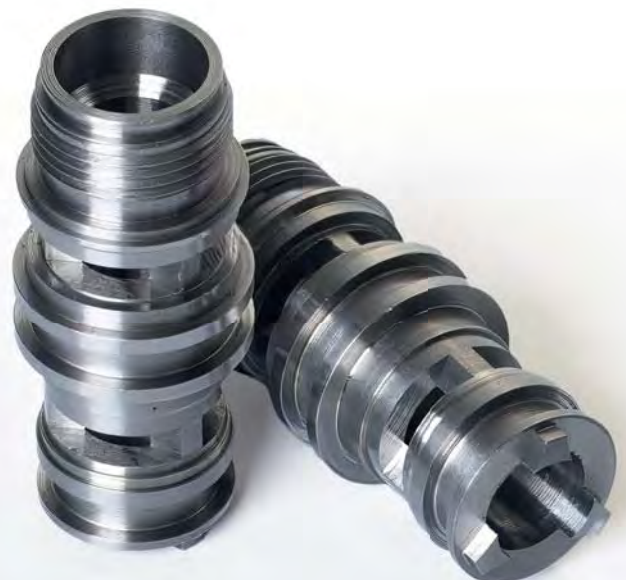
Elementy hydrauliki przemysłowej ze stali węglowej AISI 1215 obrabiane na maszynie Tornos DECO 20.
