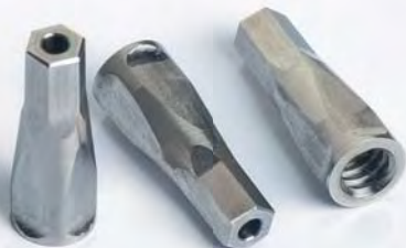
Tytanowe komponenty do instrumentów medycznych, fachowo obrabiane na Tornos DECO 20.
