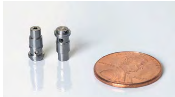
Usinado na DECO 10 da Tornos: componentes de instrumentos médicos em aço inoxidável 420.
