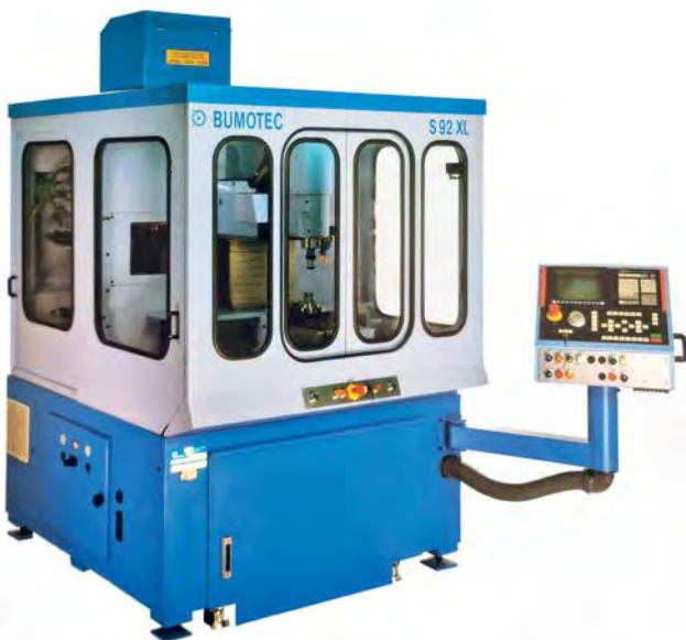
Bumotec S-92XL, máquinas CNC de 3 a 5 eixos em configuração monofuso ou multifuso, produzidas no início dos anos 90.
