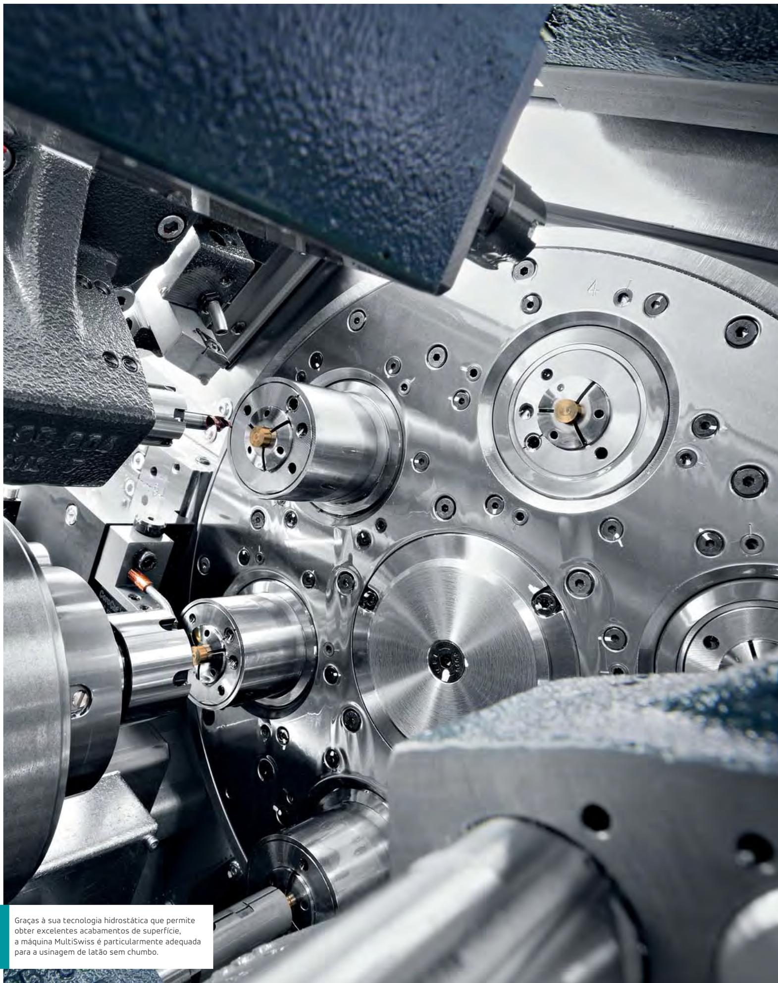
Graças à sua tecnologia hidrostática que permite obter excelentes acabamentos de superfície, a máquina MultiSwiss é particularmente adequada para a usinagem de latão sem chumbo.
