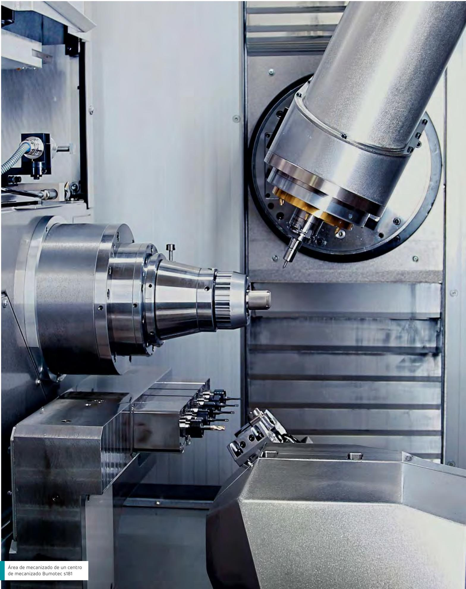
Área de mecanizado de un centro de mecanizado Bumotec s181
