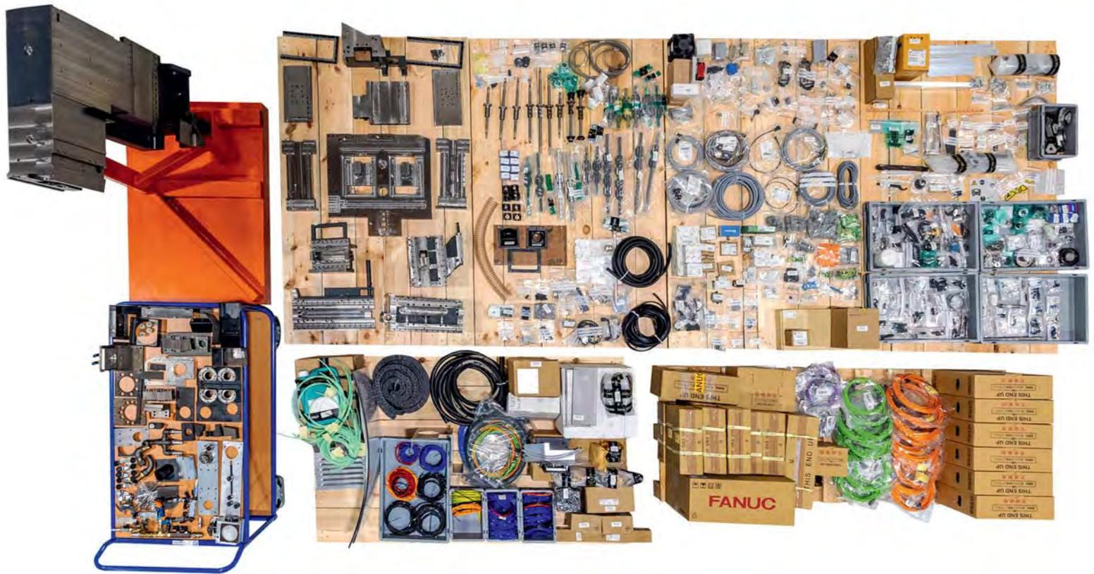
*DECO 10 ya existente, cada elemento ha sido meticulosamente desmontado, inspeccionado y modernizado. Se sustituyen componentes esenciales como los husillos de bolas y los elementos de guía, y se limpia y vuelve a pintar toda la estructura.*
