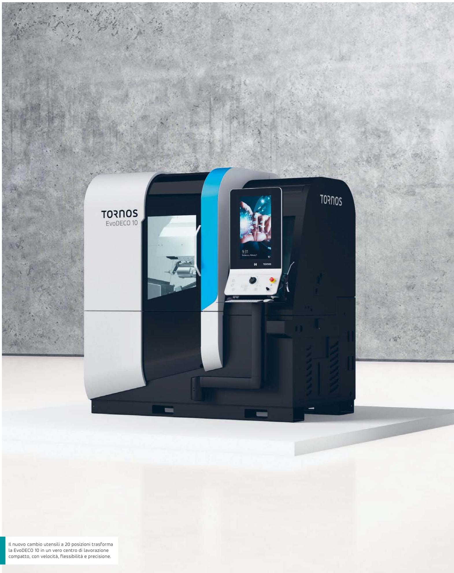
Il nuovo cambio utensili a 20 posizioni trasforma la EvoDECO 10 in un vero centro di lavorazione compatto, con velocità, flessibilità e precisione.
