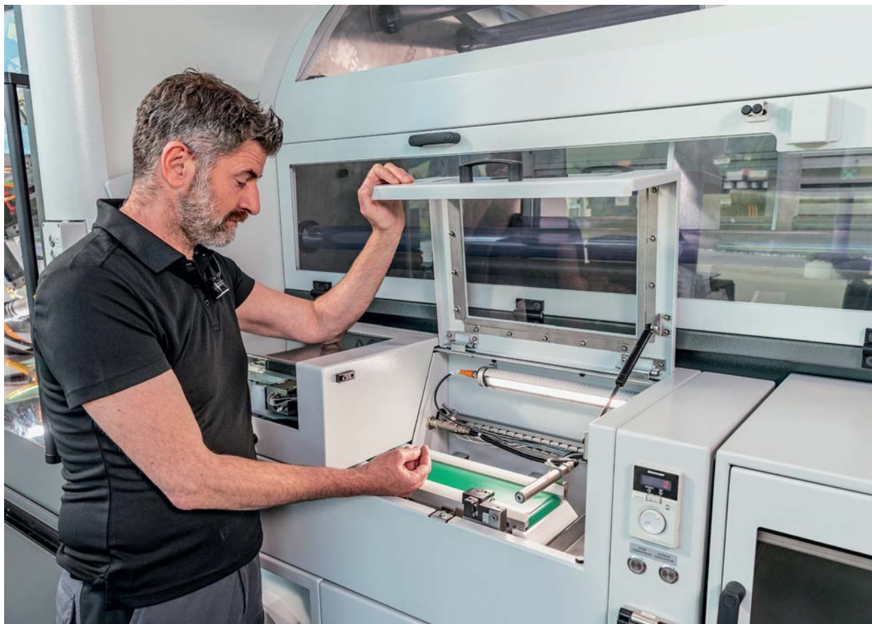
零件输送带便于进行质量控制和卸料。
