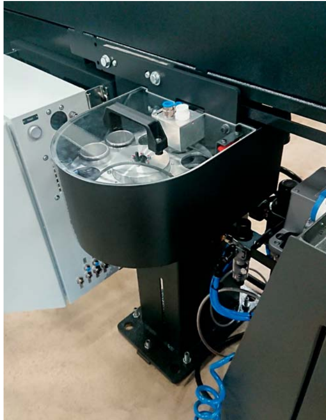
由 Tornos 专为超小型零件设计的真空转盘, 通过受控吸取系统实现可靠回收。
