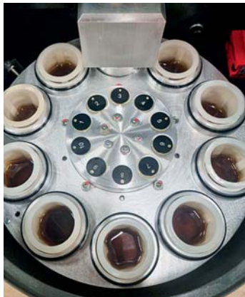
由 Tornos 专为超小型零件设计的真空转盘, 通过受控吸取系统实现可靠回收。
