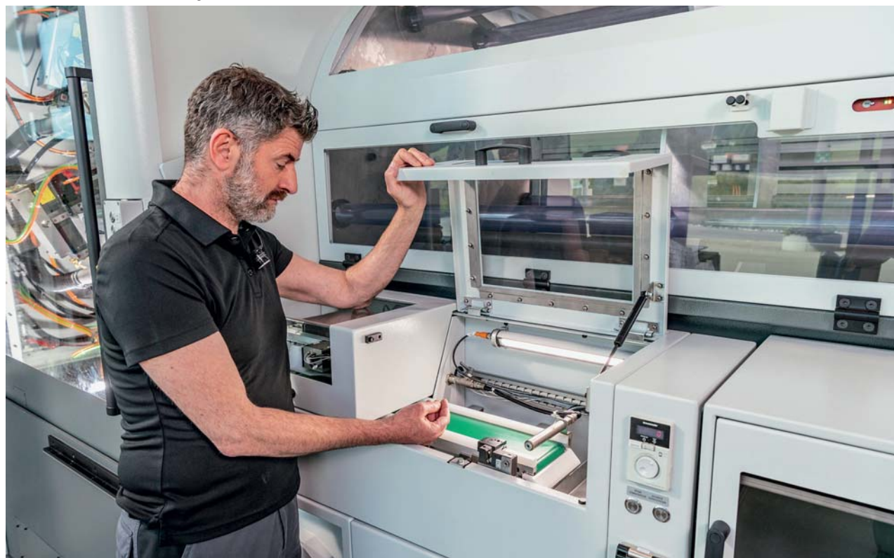
Einfacher Zugang zum Teileförderband zur Qualitätskontrolle und Entladung.
