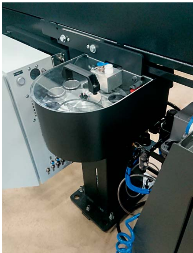
Un carrousel vacuum spécialement développé par Tornos pour la récupération fiable de pièces ultra-petites grâce à un système d'aspiration contrôlée.
