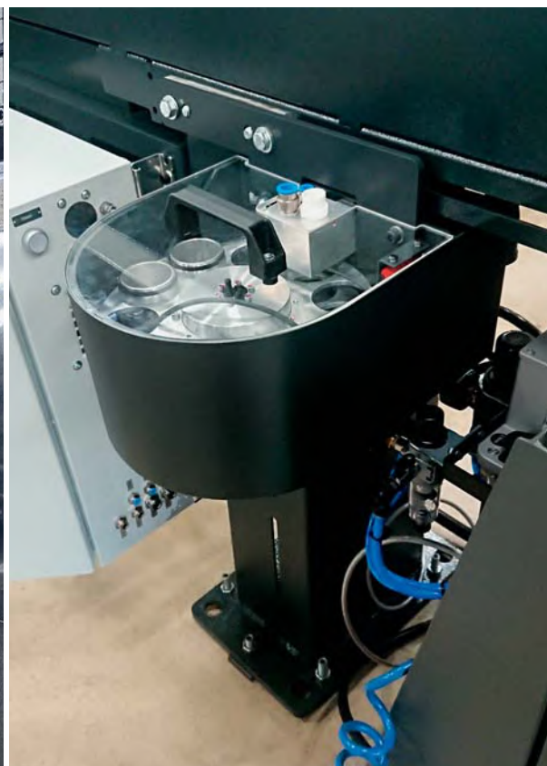
Un carrusel de vacío desarrollado especialmente por Tornos para la recuperación fiable de piezas ultrapequeñas gracias a un sistema de aspiración controlada.
