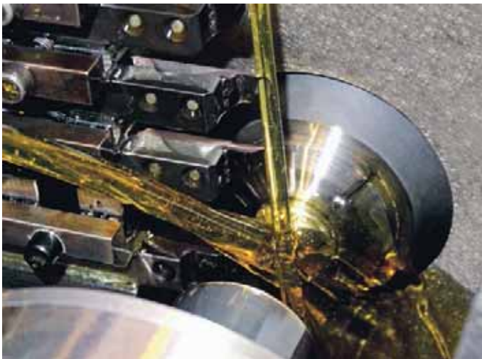
Ortho NF-X采用的Vmax技术使用了特殊添加剂，只有在特定温度下才具有活性。与使用标准切削油相比，它在性能上有重大提高。
