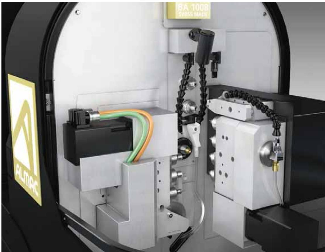
Im decomag #71 präsentieren wir das neue Vakuum-Entnahmesystem für kleine Werkstücke der SwissNano-Maschinen. Diese auch schon auf den Uhrentagen in Moutier (März 2015) gezeigte Lösung eignet sich genauso für das Entnehmen von Werkstücken, die auf der Stangenfräsmaschine Almac BA 1008 produziert werden.
