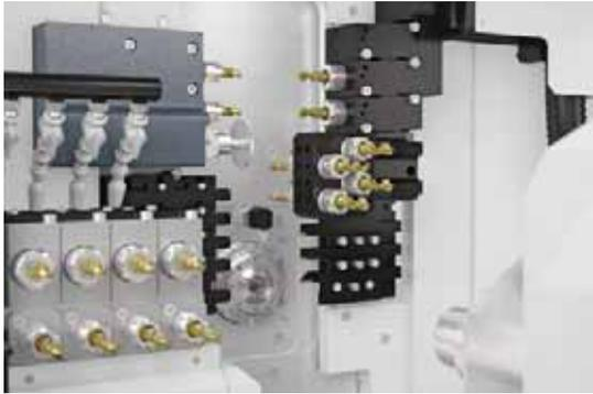
und Swiss ST 26 entwickelt wurden. Die Swiss GT 13 bietet 12 Positionen für angetriebene Werkzeuge.
