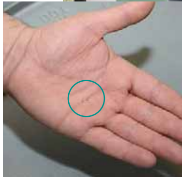
La pieza de 1,2 mm de longitud de acero inoxidable (Inox 4C 27A) fabricada en la prueba ha pasado por cuatro pasos de mecanizado y se utilizará como base de rosca en la industria relojera un millón de veces.
