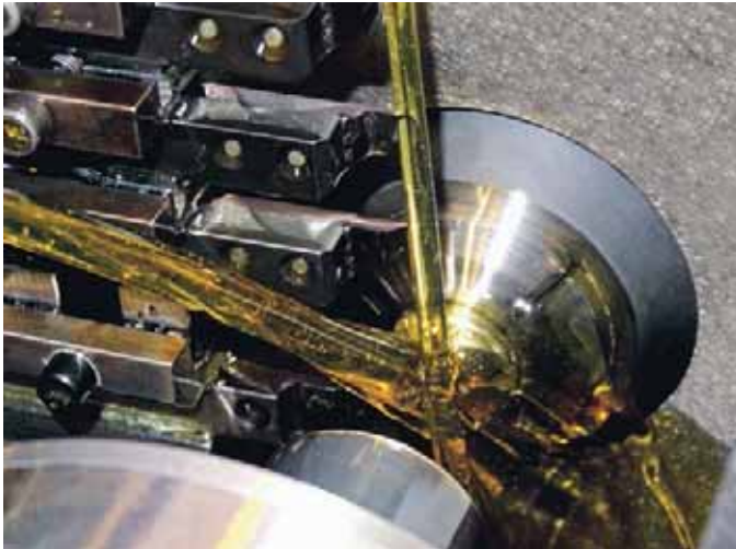
La tecnología Vmax de Ortho NF-X se centra especialmente en los aditivos que reaccionan a unas determinadas temperaturas. El incremento del rendimiento en comparación con un aceite de corte convencional es ponderable.
