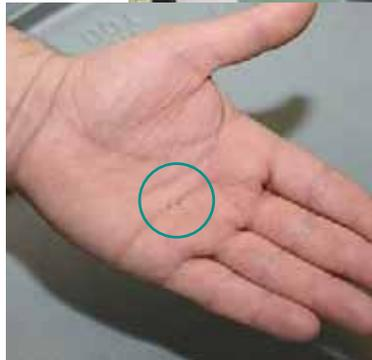
La pièce de 1,2 mm de long en acier inoxydable (Inox 4C 27A) fabriquée lors du test est passée par quatre phases d'usinage et est utilisée par millions en horlogerie en tant que pied fileté.
