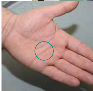
A peça de 1,2 mm de comprimento em aço inoxidável (Inox 4C 27A) fabricada durante o teste passou por quatro etapas de usinagem e é muito utilizada na relojoaria como pé roscado.
