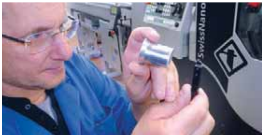
Det sätt på vilket ett verktyg slits ut och de färger det har kan förse längdsvärdet med en mängd viktig information.
