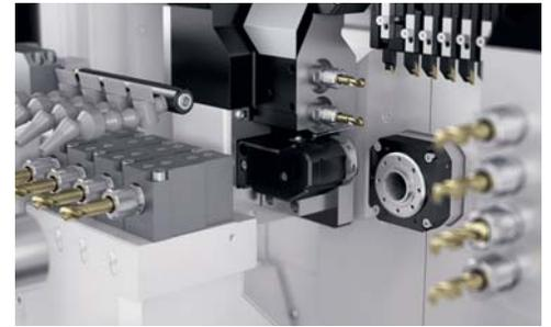
Diese Einheit wird unterhalb der beiden Spindeln für angetriebene Werkzeuge platziert, wo sich normalerweise die Schlitzfrässpindel befindet.
