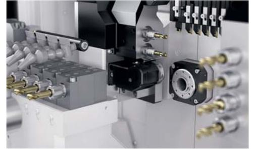
come fresa a poligonare. Quest'unità è posizionata sotto i due mandrini per gli utensili motorizzati, nella posizione in cui è generalmente installato il mandrino per scanalare.
